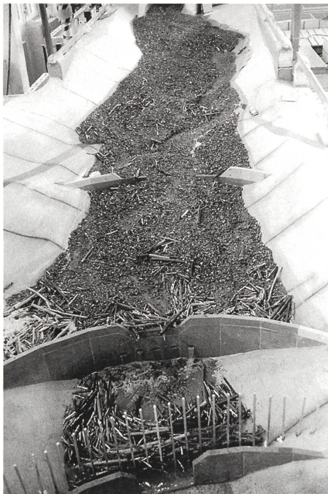
Bild 7. Räumliche Trennung von Geschiebe und Holz im hydraulischen Modell des Steinibachs ob Hergiswil NW.
