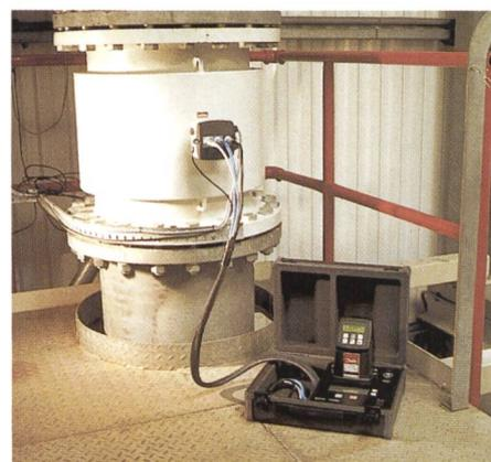
**Bild 1.** Die Überprüfung des angeschlossenen Magflo®-Messumformers und Durchfluss-Messaufnehmers mit dem Verificator dauert nur 15 Minuten. Die Speicherkapazität reicht für die Prüfung von maximal 20 Geräten. Spätestens dann muss man die Messdaten herunterladen (Werkfoto Danfoss).
