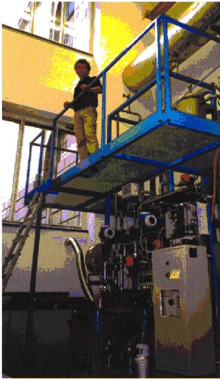
**Bild 3. Vollautomatisierter dynamischer Wärmepumpenprüfstand zum Training von FuzzyWatch und zur Untersuchung neuer Wärmepumpenregelungsstrategien für Sole-Wasser-Wärmepumpen am Institut für Mess- und Regeltechnik der ETH Zürich.**
