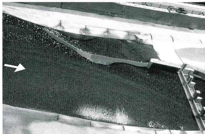
Bild 8. Blick auf die tiefen Kolke bei der Einlaufschwelle, entlang der linken Uferböschung und beim Wehrsporn nach Inbetriebnahme des Modells. Diese Kolklöcher haben sich in Natur – mit Ausnahme des Kolks beim Wehrsporn – nicht gebildet. Mit dem anfänglich gewählten Modell-Dispositiv kann die Sohlenlage in Natur nicht nachgebildet werden.
