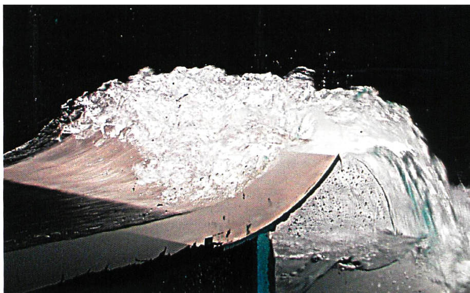
Bild 8. Strömungszusammenbruch bei abnehmendem Durchfluss ( Q_- ), für R = 0,40 m, \beta = 40^\circ .
