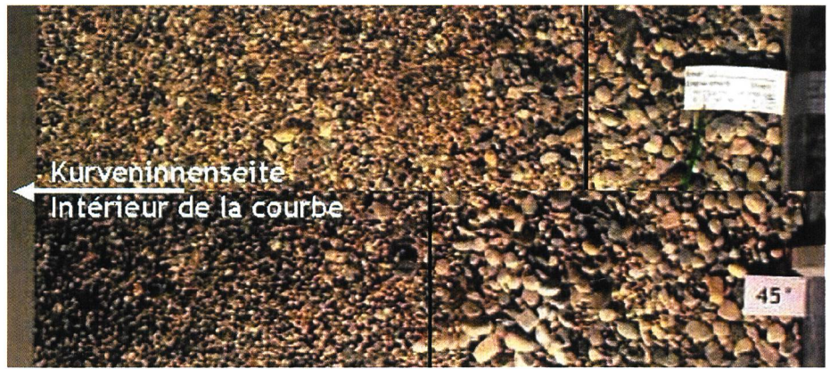
Bild 4. Sortierungsprozess in Querrichtung; ohne Rippen (oben), mit Rippen (unten). Figure 4. Tri granulométrique radial; sans nervures (en haut), avec nervures (en bas).
