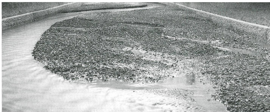
Bild 11. Verzweigtes Gerinne im hydraulischen Labor: Ausgeprägtes Verzweigungsmuster in einem Gerinne mit Ablagerungstendenz (oben) und eingetieftes Einzelgerinne bei anhaltender Erosionstendenz (unten) (Foto: VAW-ETHZ).
