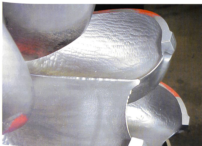
Bild 6. Schäden im Innern der Becher der Peltonturbine des Kraftwerks Kandergrund.
