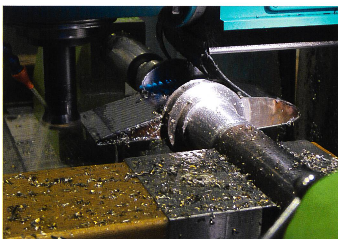
Bild 5. Bearbeitung der geschweissten Leitschaufel.
