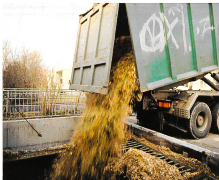
Bild 2. Holzschnitzel auffüllen (Fotos: Atelier Siegfried, Basel).
