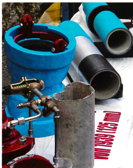
Bild 2. Vor über 65 Jahren wurden die Trinkwasserleitungen aus Eternit (Vordergrund) erstellt. 2004 erfolgte der Bau der Ersatzdruckleitung, die aus beschichteten Gussrohren besteht.
