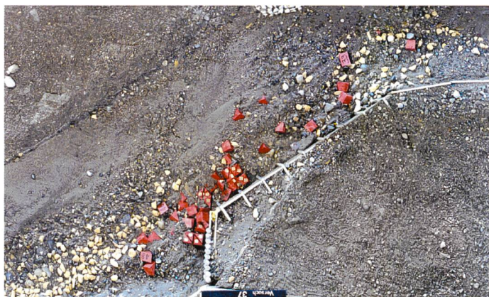
Bild 12. Flussaufwärtiges Ende der rechten Uferschutzmauer im hydraulischen Modell Gurtneilen nach der Simulation eines Extremereignisses mit einem Abfluss von 1000 m³/s. Rund 1/4 der zum Schutz der Mauer versetzten Prismen wurde abtransportiert (Fließrichtung von links nach rechts).
