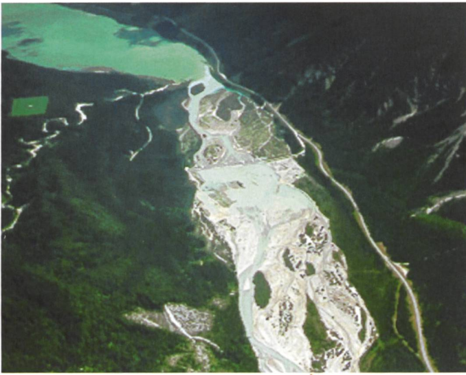
Bild 7. Wurzel des Speichers Sylvenstein mit einem Geschiebesammler im Hauptzufluss.
