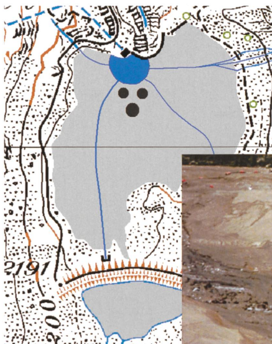
Figure 13. A gauche: Disposition des tas dans la retenue pour le curage du bassin; à droite: augmentation de l'efficacité du curage par déplacement des matériaux solides à l'intérieur de la retenue à l'aide de moyens mécaniques (photo: D. Job, Colenco).
