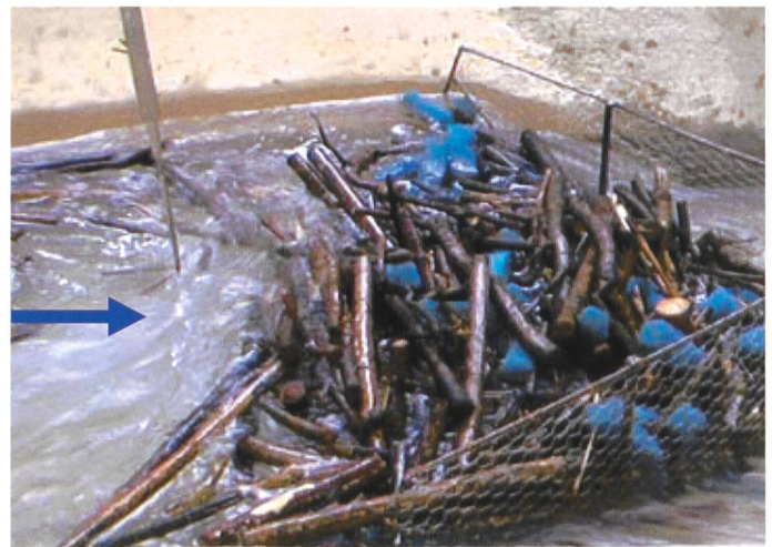
Bild 10. links: Modellversuche zu «Teilnetzen» in Kurven; rechts: Modellversuch zu v-förmigen Netzen.
