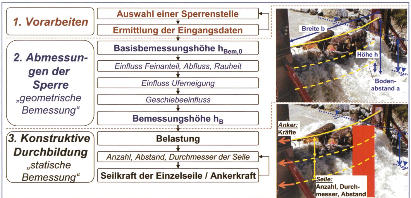
Bild 2. Ablauf der Bemessung von Seilnetzsperrern zum Schwemmholzurückhalt.
