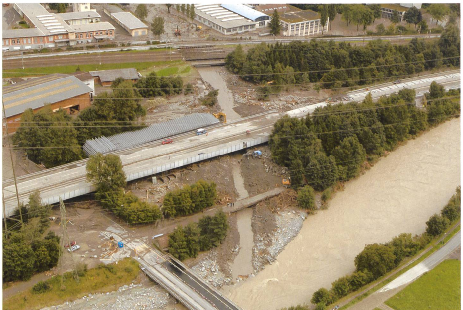
Bild 1. Geschiebeablagerungen im Schächen nahe der Mündung in die Reuss während des Hochwasserereignisses 2005, Kanton Uri (Foto: Kanton Uri).
