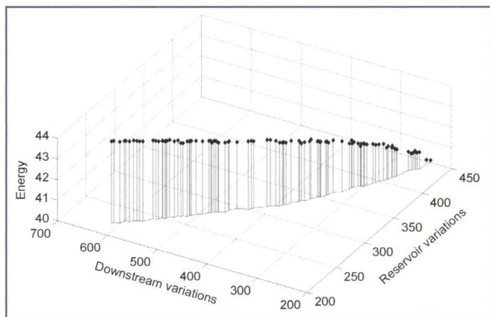
**Bild 7. Pareto-Optimierung für die Energieproduktion (GWh/Jahr), unterstromige Wasserspiegelschwankungen (m³/s/min/Jahr) und Speichervariation (m/Jahr).**
