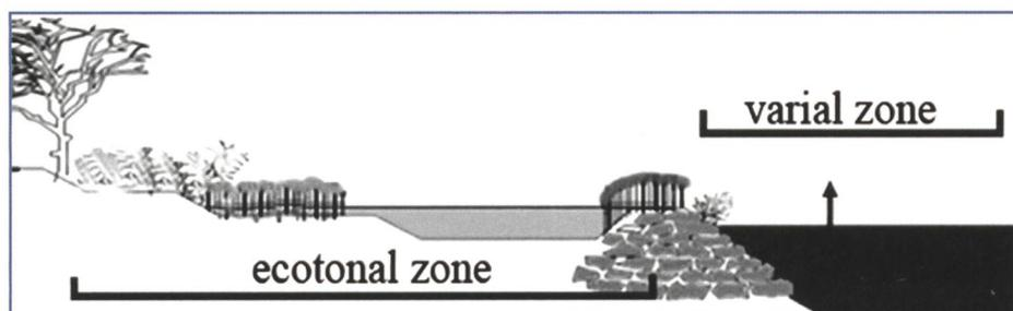
Bild 3. Schutz der Wasser-Land-Wechselzone des Mehrzweckspeichers durch einen überströmbaren Damm.
