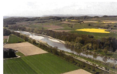
Bild 3. Flussaufweitung an der Thur bei Niederneunforn. Linke Flussseite mit Damm als Schutz der landwirtschaftlichen Siedlungen. Rechte Seite mit altem Auenwald. Quelle: BHAtteam, Ch. Hermann.
