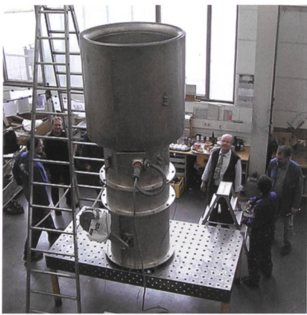
Bild 5. Vibrationsmessungen an der 18,5-kW-Turbine.
