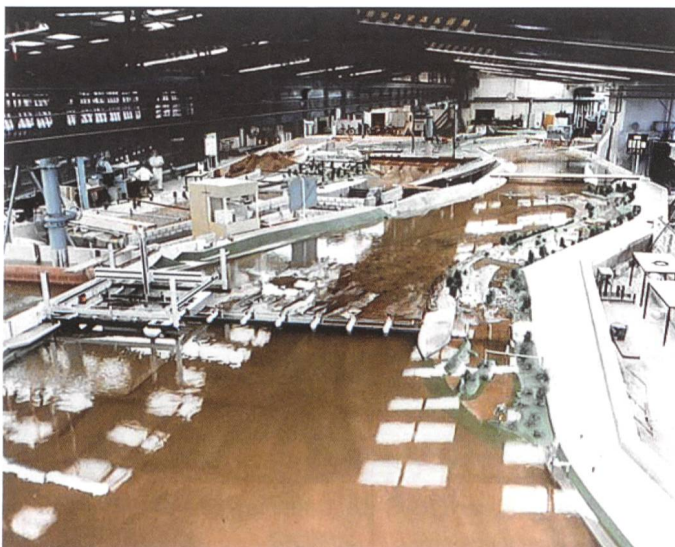
Bild 7. Hydraulisches Modell Gesamtanlage.
