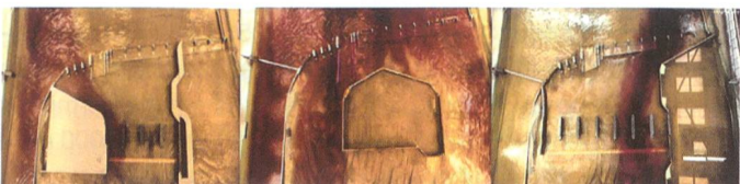
Bild 8. Hydraulisches Modell Baugruben.
