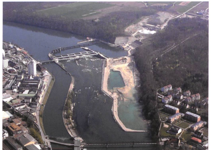
Bild 30. Beginn der Rheineintiefung im Schutze eines Schüttdammes.
