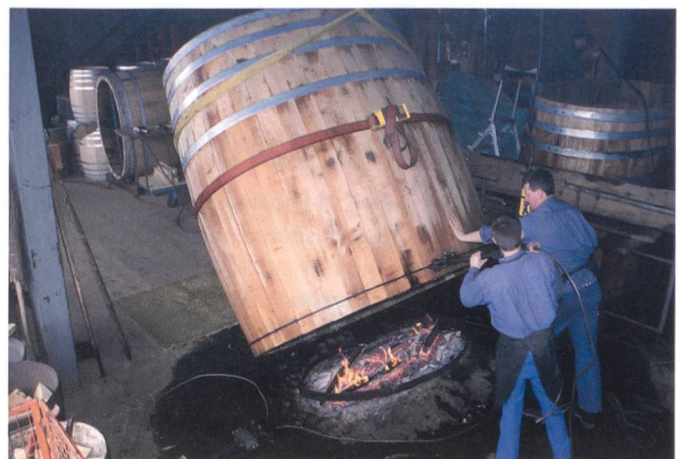
Bild 2. Biegen der Dauben mit Wasser und Feuer.
