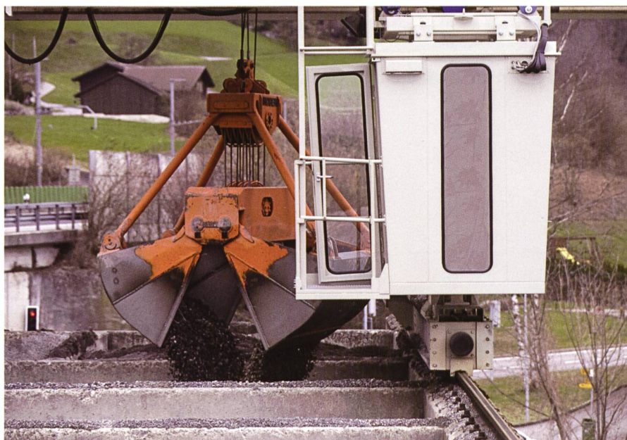
Bild 2. Das Kies- bzw. Sandmaterial gelangt nach Komponenten getrennt in die verschiedenen Kammern der Siloanlage. Im Vordergrund die moderne, fahrbare Vollsichtkanzel für den Kranführer.
