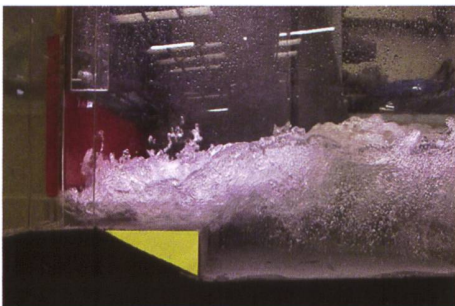
Bild 3. Hydraulische Modellversuche mit der alten Sohle (oben) und mit der neuen Betonsohle (unten); der Knick in der Sohle wurde durch eine senkrechte Wand ersetzt, so dass der Strahl abreißen kann. Die fast gleichmässige Strömung der alten Form sieht auf den ersten Blick im Modell «schön» aus, führt aber zu teilweise erheblichem Unterdruck.
