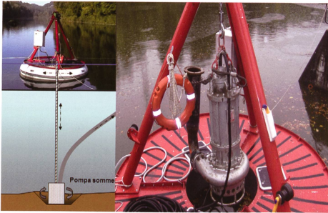
Bild 4. Aufnahme des anlässlich der Testbaggerung eingesetzten Saugbaggers SMART LIGHT auf dem Gübensee.
