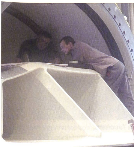
Bild 8. Die Schieber für die Grundablässe sind aktuell in Fabrikation. Die Abnahme ist für Herbst 2010 geplant.
