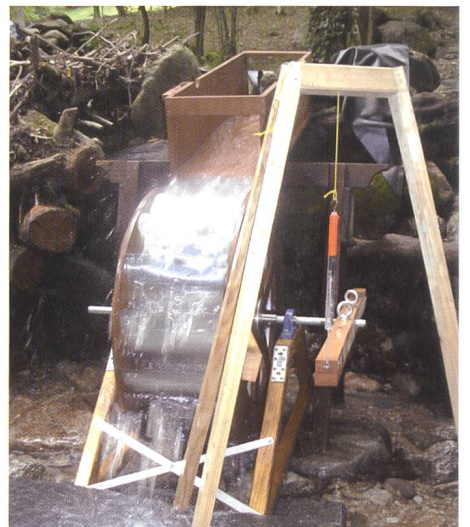
Bild 8.14. Das Rad mit 3 N/m Belastung und einer Zuflussmenge von 2 l/s.
