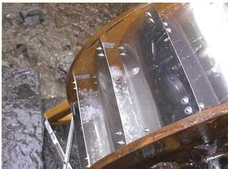
Bild 8.9. Sicht auf den Füllstand der Schaufeln.
