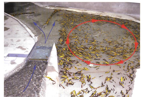
Bild 9. Situation nach einem EHQ mit der gewählten Bestvariante: angedeutet sind die «Hauptströmungsrichtungen» und die Rezirkulationszone im Holzurückhaltebereich.
