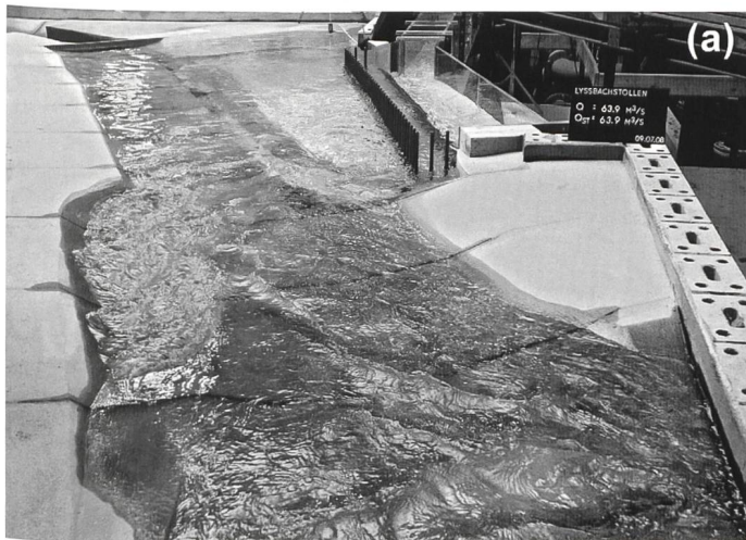
Bild 4. Strömungsbild beim Einlaufbauwerk bei EHQ mit geschlossenem Drosselwehr, (a) Ausgangsentwurf und (b) Ausführungsvorschlag.
