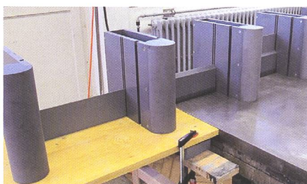
Bild 3. Fertigung der Wehranlage aus PVC (Foto: VAW-ETHZ).
