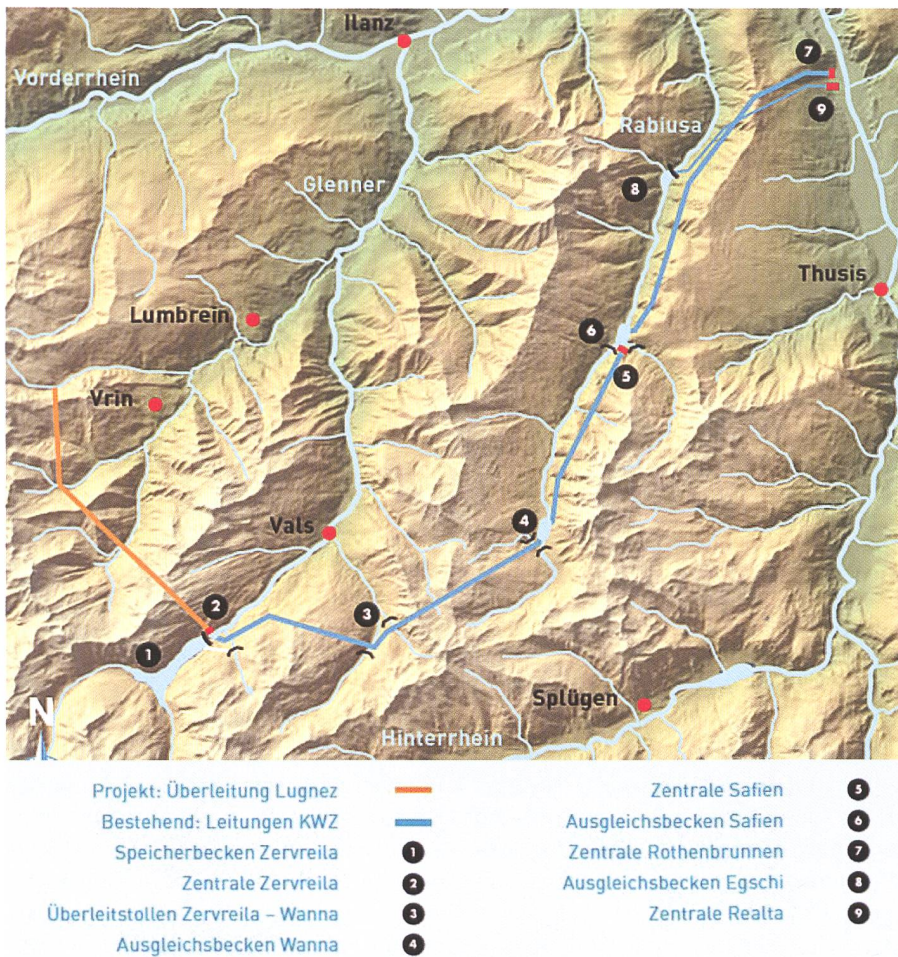
Bild 1. Karte der bestehenden Anlagen KWZ und geplante Überleitung aus dem Lugnez (KWZ).
