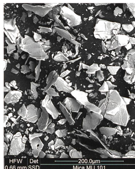
Bild 3. Mineralische Partikel, welche in den Laborversuchen betreffend Schwebstoffmessung verwendet wurden: Feldspatpulver (links, d_{50} = 34 \mu\text{m} ), Glimmerpulver (Mitte, " d_{50} " = 45 \mu\text{m} ) und Quarzfeinsand (rechts, d_{50} = 147 \mu\text{m} ) (Bilder: VAW und IfB, ETH Zürich).
