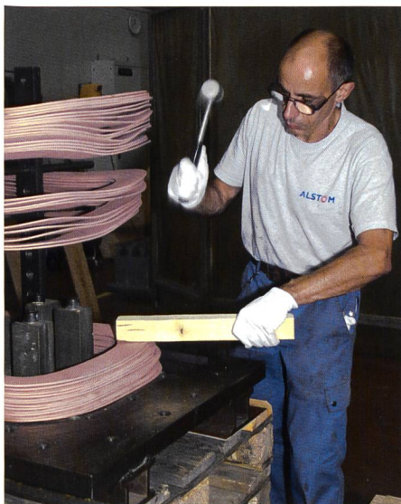
Bild 6. Neuinsolation einer Polwicklung.
