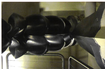
Bild 2. Eine der drei neuen vertikalachsen Pelton-turbinen mit 5 Injektoren bei der Zentrale Navisence (Foto: Pfa).
