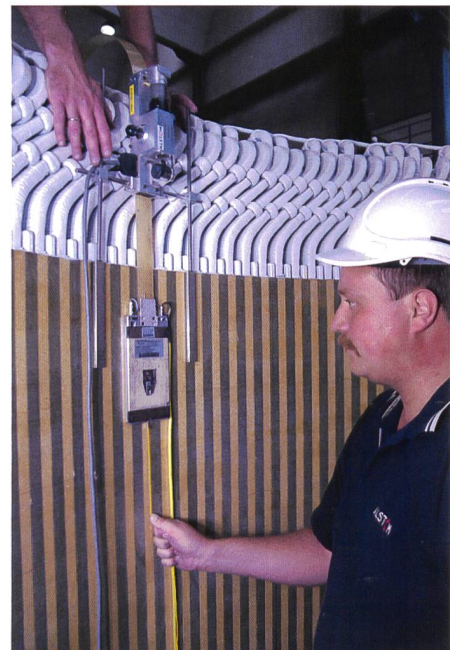
Bild 1: Nutverkeil-Kontrolle mit Roboter.
