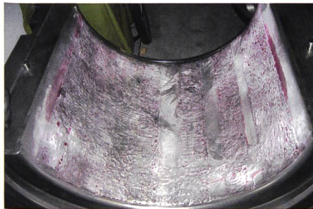
Bild 4. Reparatur des Weissmetalls einer Lagerschale: oft ist es nicht erforderlich, das komplette Lager neu auszugießen.
