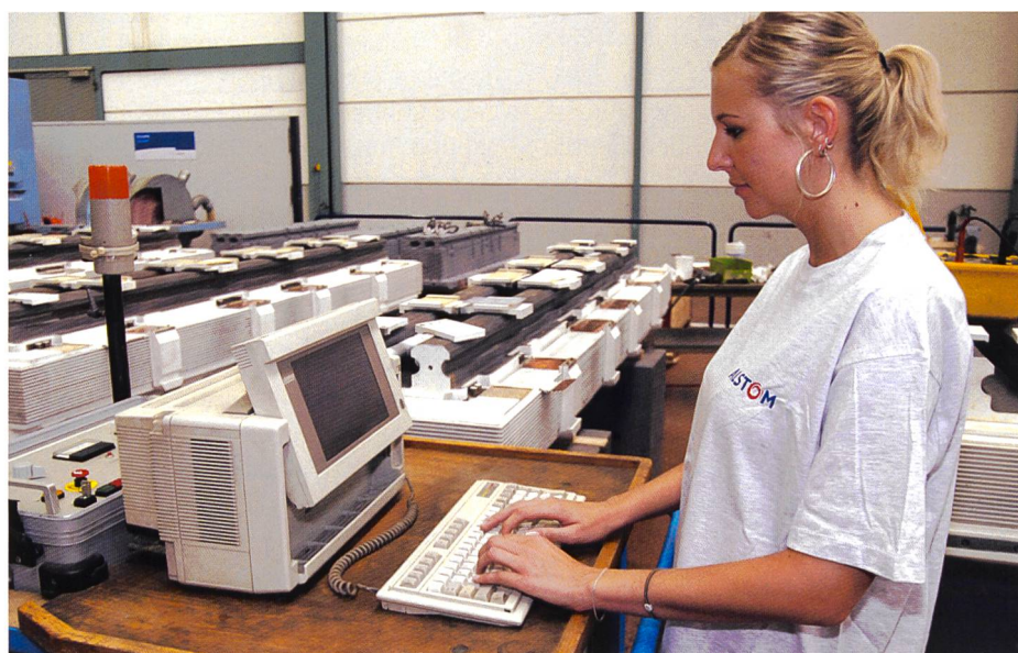
Bild 2. Elektrische Abnahmeprüfungen an Polen im Werk Birr.
