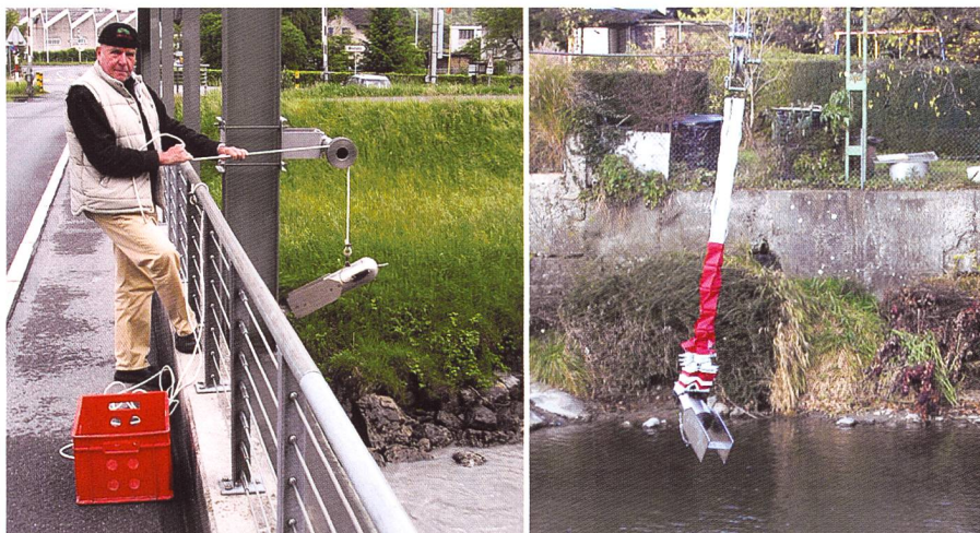
Bild 7. Zweimal wöchentlich durchgeführte Probeentnahme von einer Brücke aus (links) oder mit einer Seilkrananlage einer hydrometrischen Station (rechts).
