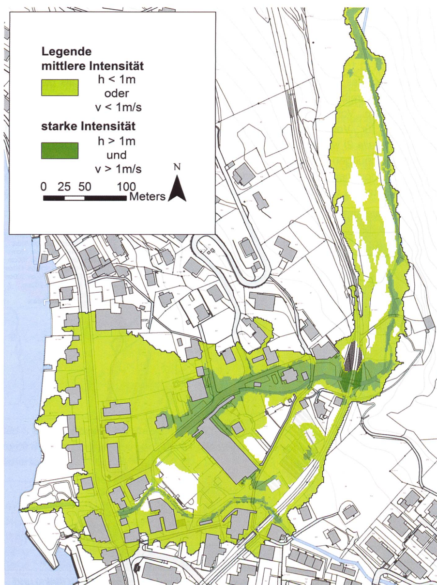
Bild 4. Intensitätskarte im IST-Zustand für 300-jährliche Ereignisse auf Basis der Berechnungen in RAMMS.
