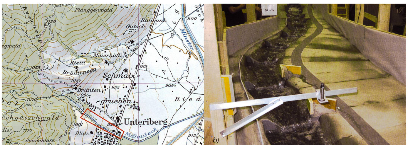
Bild 3. Links: Rot markierter Modellperimeter, rechts: Ausleitstrecke mit Leitsporen.
