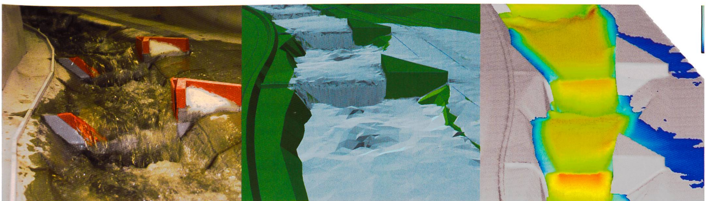
Bild 8. Abfluss von 85 m³/s, hydraulisches Modell, 2-D-Modell, 3-D-Modell.
