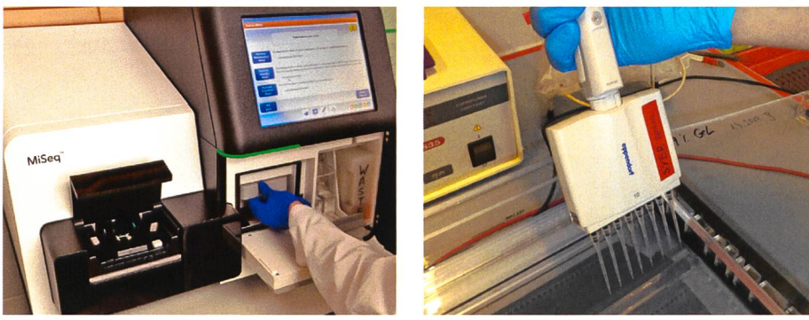
Bild 2. HTS-Plattform Illumina MiSeq. Pipettiervorgang, ein typischer Arbeitsschritt.
