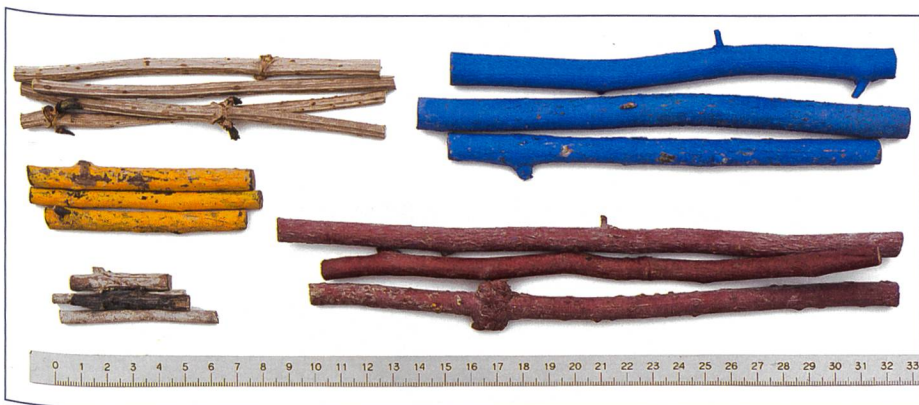
Bild 4. Modellschwemmholz in 5 Klassen (Massstab 1:40).
