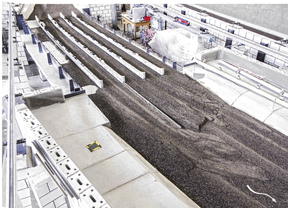
Bild 14. Auflandungen unterstrom HB Zürich im hydraulischen Modell (Massstab 1:30).
