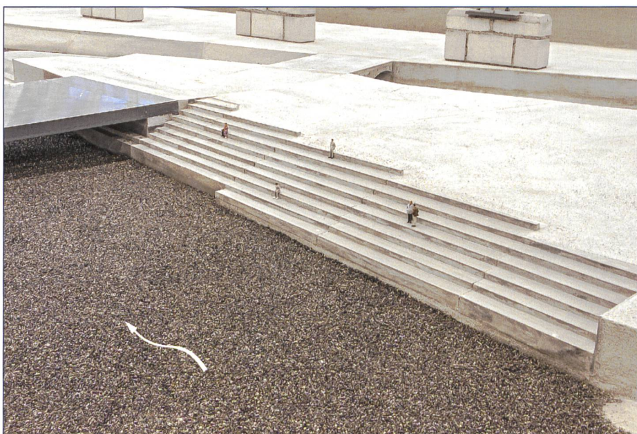
Bild 12. Sitzstufen bei Sigi-Feigel-Terrasse im hydraulischen Modell (Massstab 1:30).
