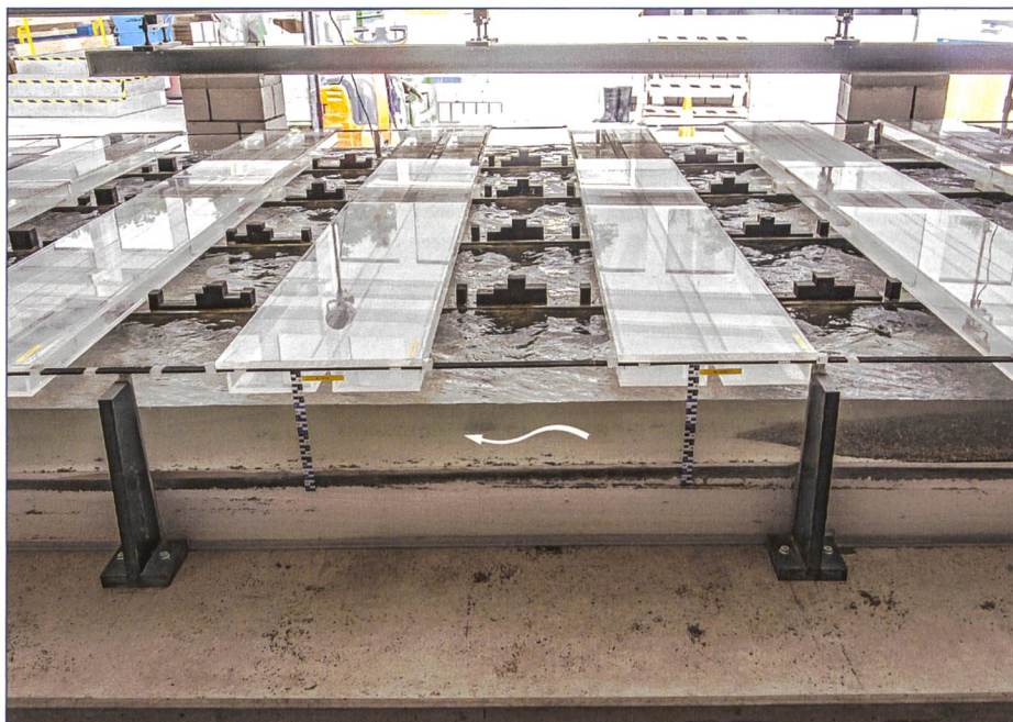
Bild 11. Sihldurchlässe mit Nachbildungen der Gleisbrücken und Widerlager im hydraulischen Modell (Massstab 1:30).
