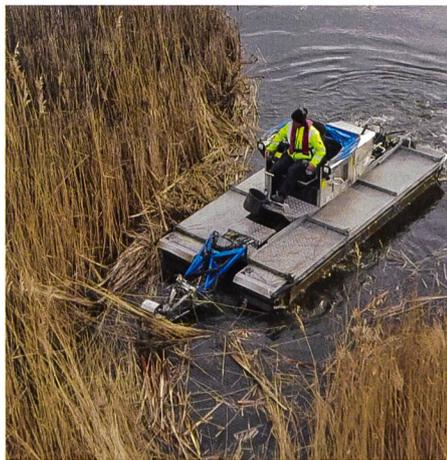
**Amphimaster bei Schilfschneidearbeiten.**
