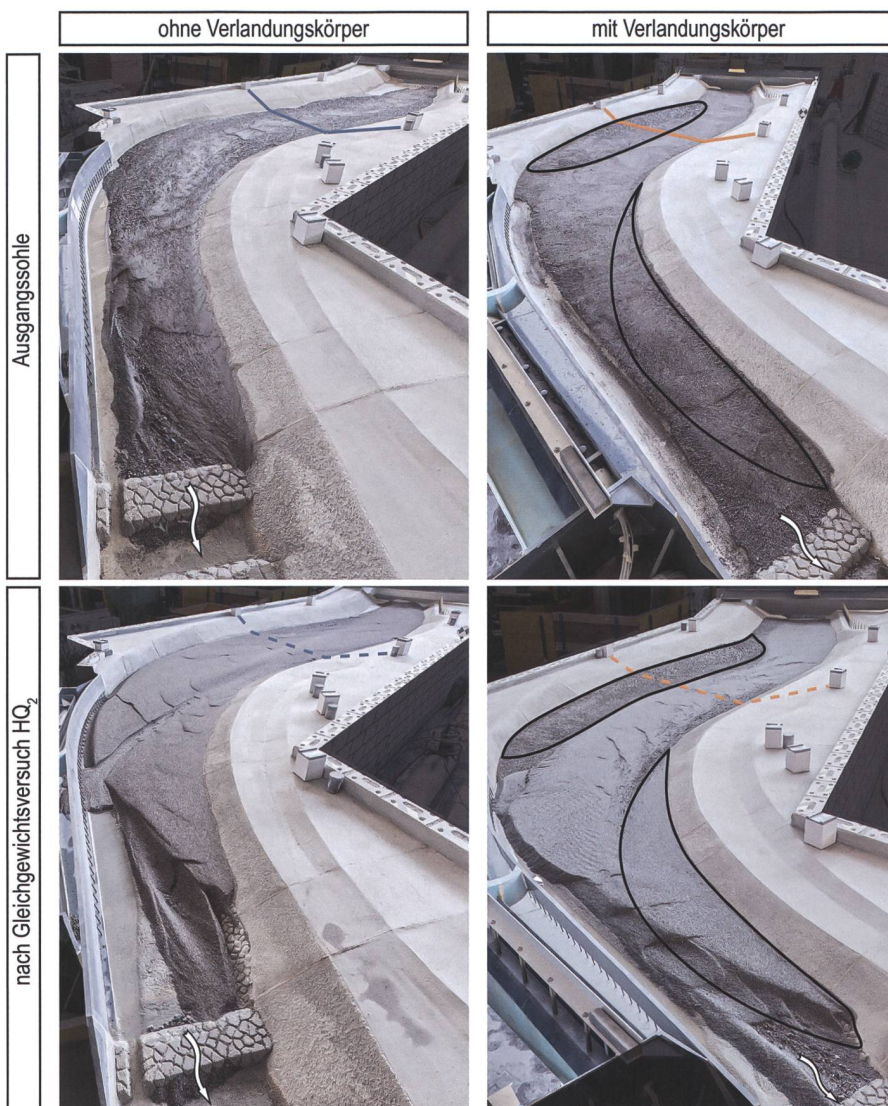
Bild 5: Sohle vor (oben) und nach (unten) stationären Gleichgewichtsversuchen bei HQ_2 . Im Versuch ohne Verlandungskörper (links) landete deutlich mehr laufendes Geschiebe auf als im Versuch mit Verlandungskörpern (rechts).
