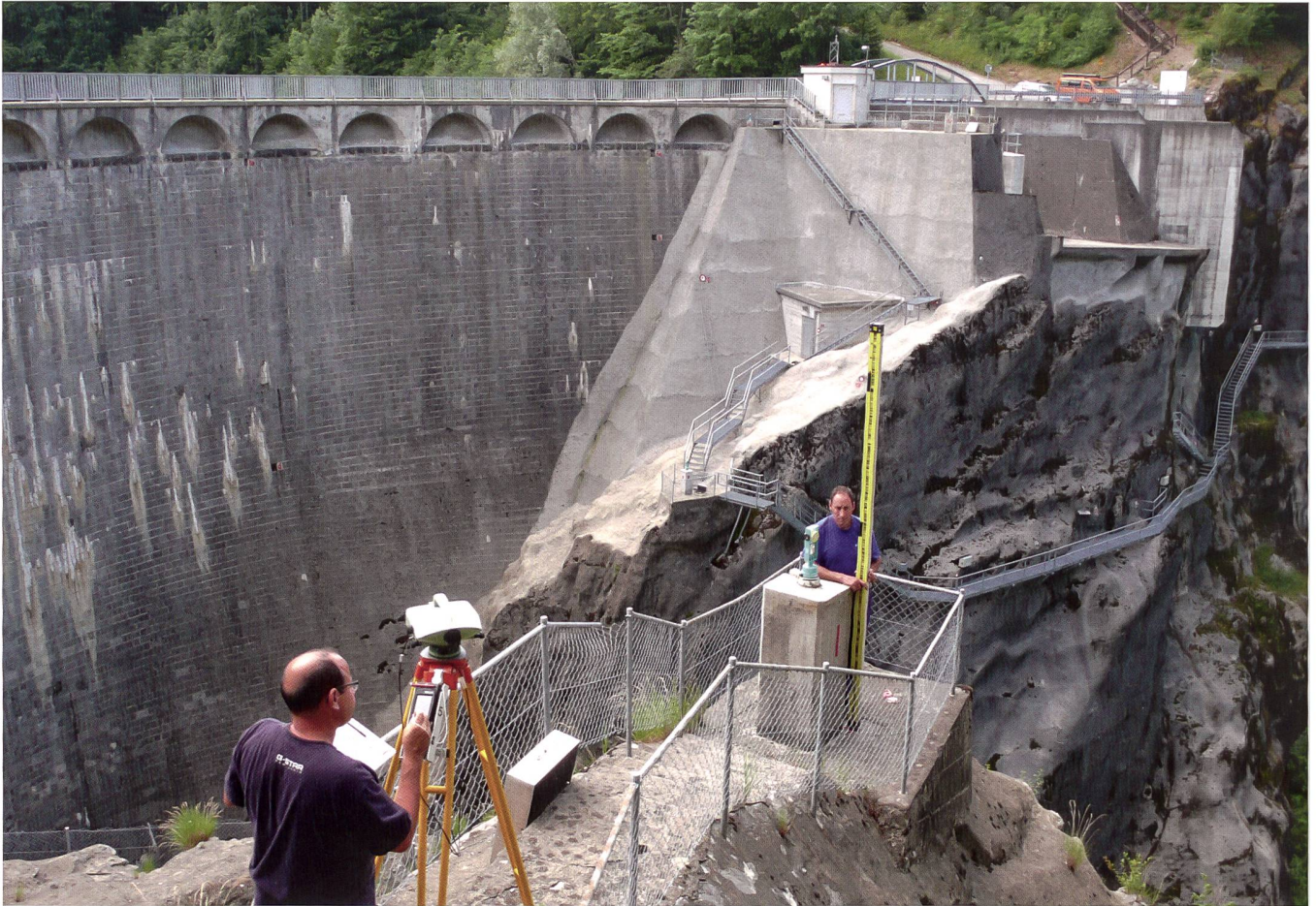
Bild 6: Staumauer Montsalvens 2014: Alain Wicht und Jean Ecoffey bei Nivellementmessungen beim Pfeiler 1. (M. Kistler, © Bundesamt für Landestopografie swisstopo).
