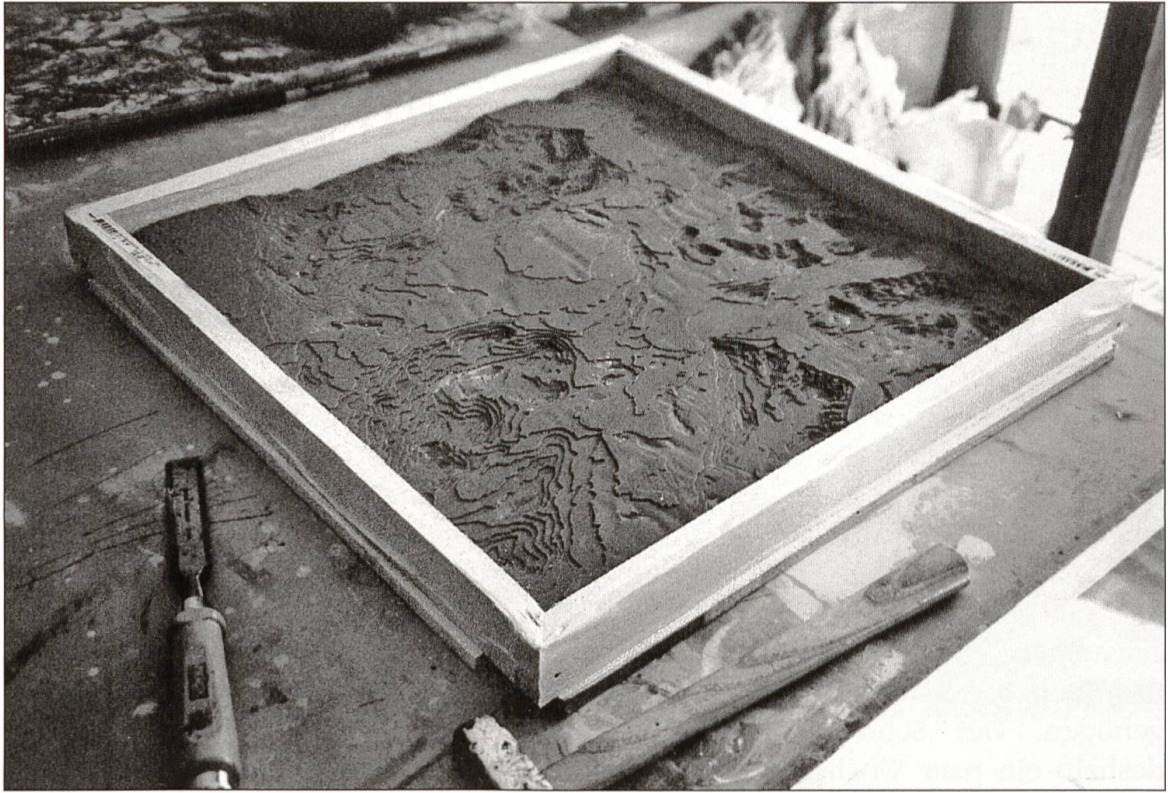
Von diesem Treppenstufenmodell wird in einem Rahmen ein Negativ in Silikonkautschuk gegossen.
