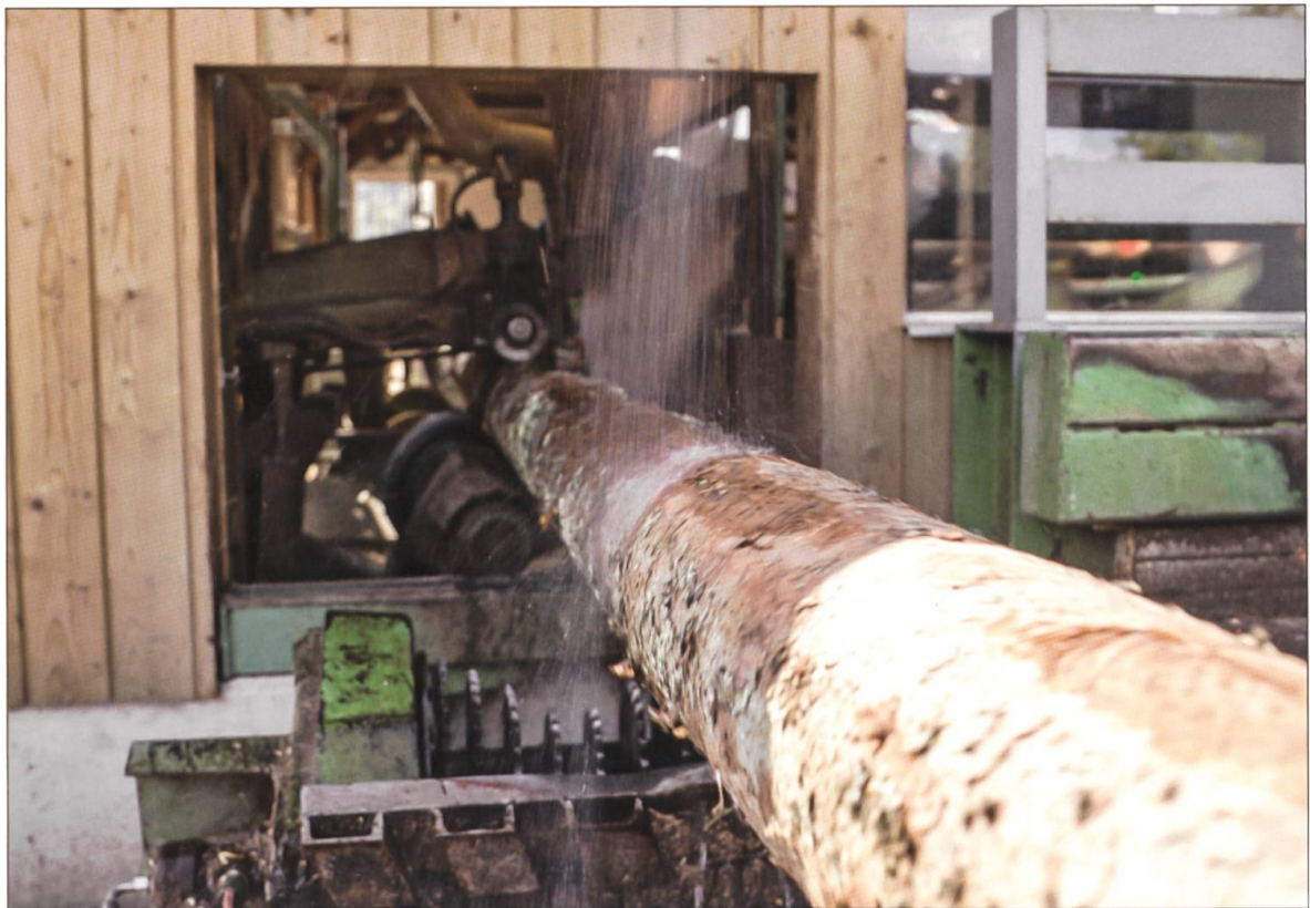
Schälen von Rundholz zur Herstellung von Masten.
