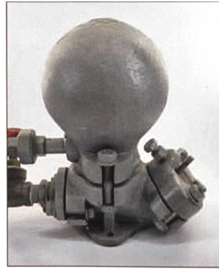
Schlumpf, hydraulischer Widder 1/05 (ab Jahrgang 1905).
