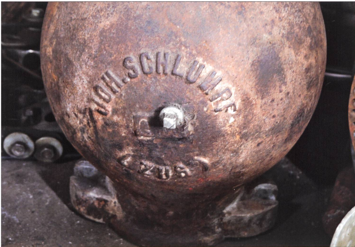
Das über hundert Jahre alte gegossene Gehäuse des Windkessels mit dem Namen des Schweizer Herstellers.
