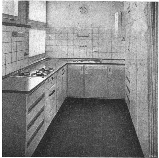
Moderne Gasküche, bei welcher die drei Werkplätze Kochherd, Rüst- und Abstelltisch sowie Spültrog in L-förmigem Block angeordnet sind. Überall sind genügend Abstellflächen vorhanden. Kasten dienen der Unterbringung des Kücheninventars.
