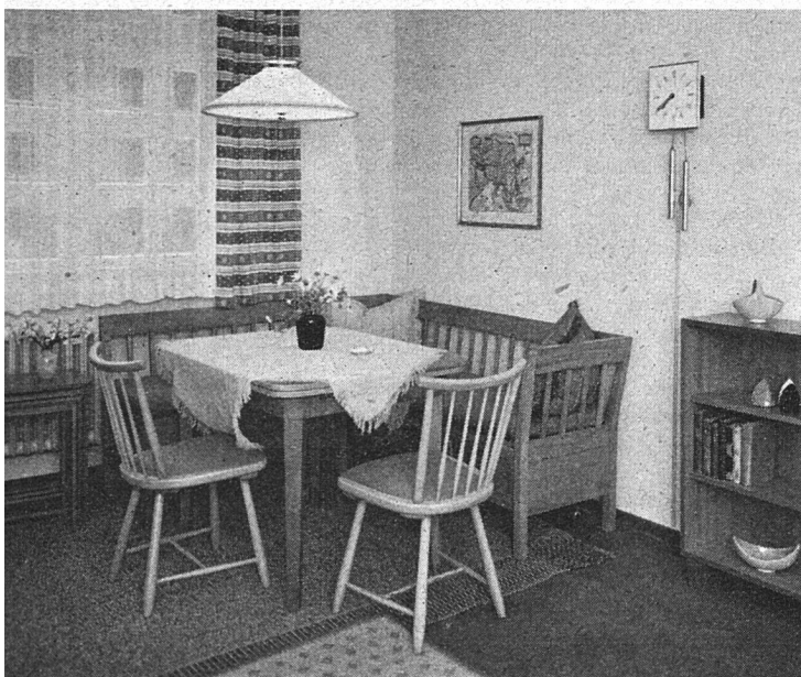
Wohnzimmersitzzecke mit einer Zugpendelleuchte beleuchtet. Der Deckenauslaß befindet sich nicht in der Zimmermitte. (1)
