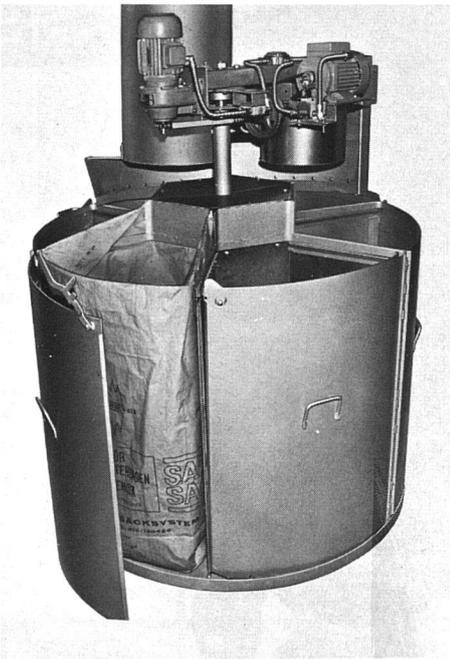
Der Hausmüll wird verpackt in ein Müllschachtröhre geworfen. Im Keller des Gebäudes fällt er in einen Gross-Papiersack. Der Müll-Komprimator verdichtet automatisch den Müll im Sack. Ist dieser voll, dreht sich das Karussell, und ein leerer Sack ist wieder bereit.
