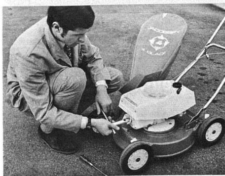
Brennstoff aus Tank und Vergaser entfernen: Benzinrückstände könnten bis im Frühjahr den Vergaser verstopfen. Am 4-Takt-Motor Ölwechsel vornehmen. Der Luftfiltereinsatz muss nach Vorschrift gereinigt werden.
