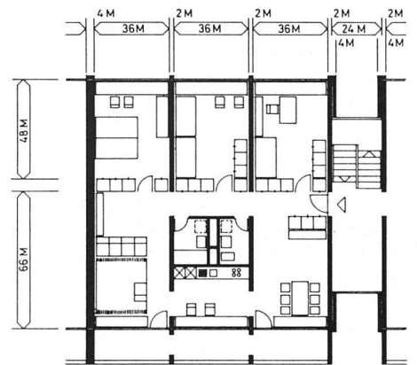
Balkonseitig orientierter Wohn- und Essraum
