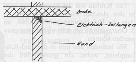
Problem: Der Kronenabschluss der Tragwand mit der Decke bot einer Traube von Elektrokabeln «Schutz». Eine 15 cm dicke Wand wurde teilweise von wenigen nackten 2 cm bis 6 cm Mauerwerten «am Hals» getragen.
