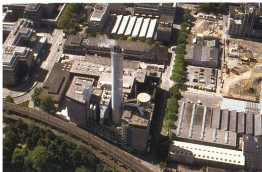
Die Wärme aus der Kehrichtverbrennungsanlage Hagenholz wird über lange Leitungssysteme bis zu öffentlichen Gebäuden im Stadtzentrum geleitet.
