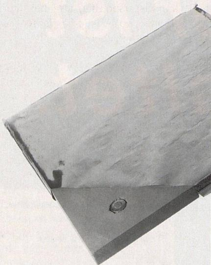
Aufbau eines Vakuum-Dämmpaneels mit einem Kern aus gepresster Kieselsäure. Die Hüllfolie ist fünfplagig, um optimale Eigenschaften zu erreichen.
