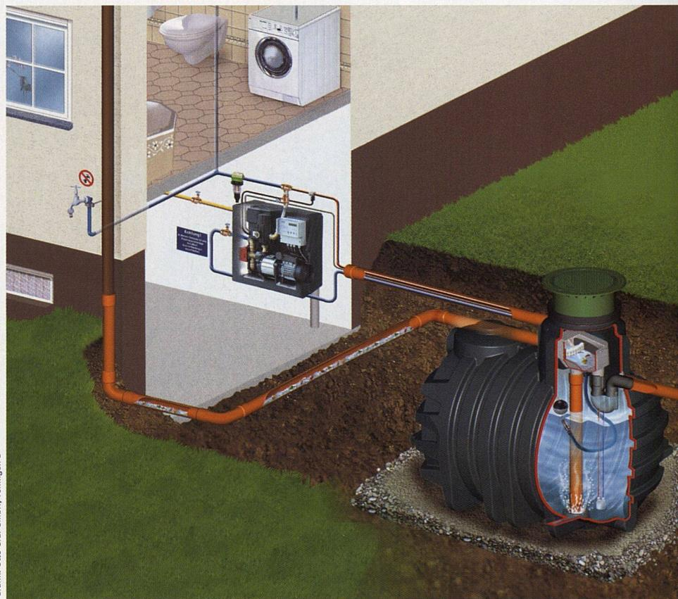
So funktioniert ein moderner Regenwassertank: Diese Anlage für die Garten- und Hausnutzung verfügt über ein so genanntes Not-Nachspeisemodul. Sollte der Tank zu wenig Wasser haben, tritt es automatisch in Aktion. Neu ist, dass hier
